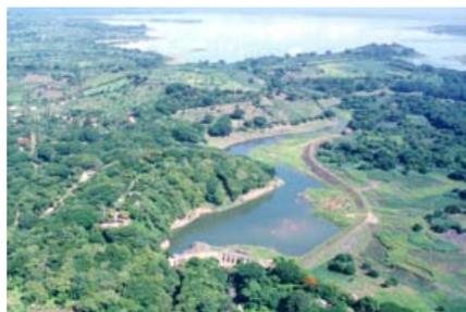
finalizada en 1963 y cuenta con una capacidad instalada total de 15 MW por una sola unidad. El embalse de este proyecto hidroeléctrico con un área de drenaje de 2.768 km<sup>2</sup> está basado en la Laguna de Guija, cuyo nivel fue elevado aproximadamente 10m por un dique de hormigón armado.
